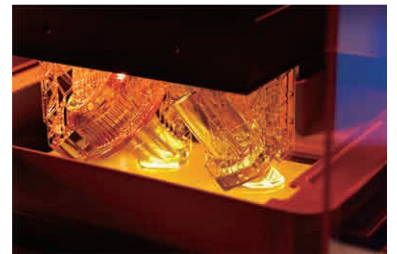
レーザーユニット 4 (LPU 4) がバックライトユニットから放射される光線をレイヤーの形状に正確に再現。
